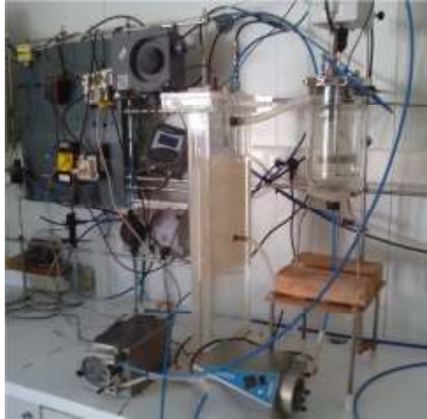
Figura 3.1. Montaje del MBR de 4.5 L
