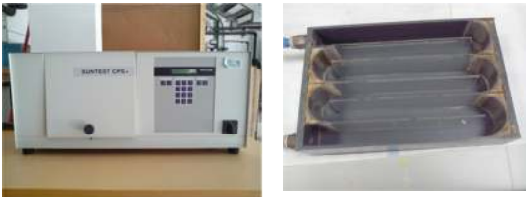
Figura 3.9. Fotografías del simulador solar (izquierda) y reactor raceway (derecha).
